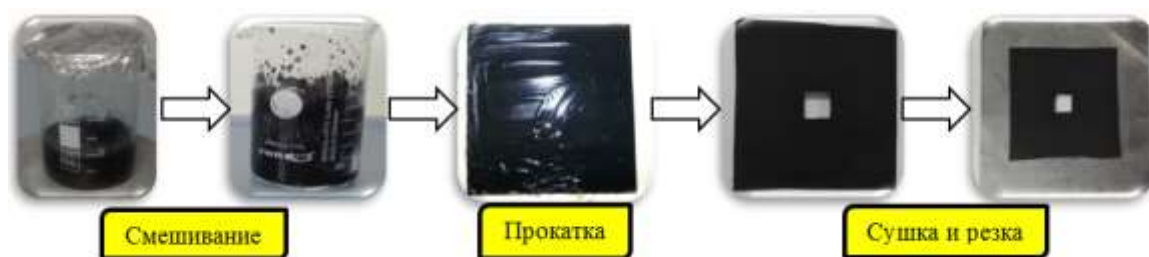
Рисунок 9 – Стадии изготовления композитных электродов и внешний вид полученных композитных электродов
