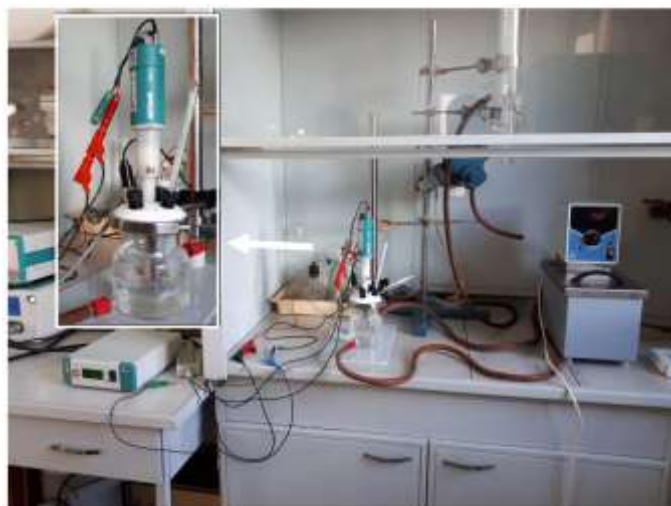
Рисунок 15 – Лабораторное оборудование для электроосаждения золота: модульный потенциостат-гальваностат AUTOLAB PGSTAT 302 подключенный к термостату
