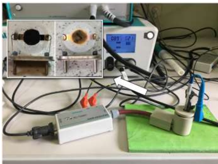
Рисунок 16 – Фотография сборки ЭКМ рабочей станции Autolab с трехэлектродной ячейки
